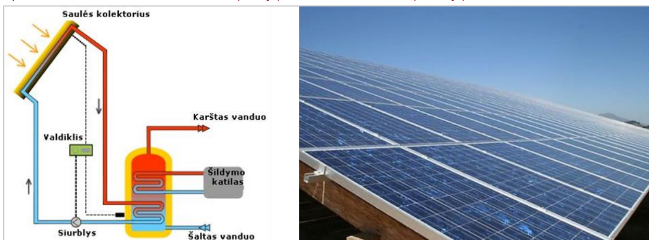
7 pav. Saulės kolektoriaus veikimo schema (kairėje) ir saulės fotoelementai (dešinėje)
